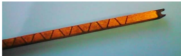
Fig. 2.1: Transversal slot waveguide antenna.
