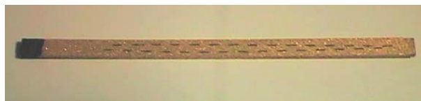
Fig. 2.4: Longitudinal slot waveguide antenna.
