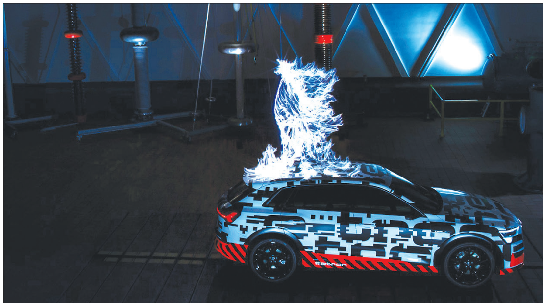
Съвременните автомобили са своеобразни Фарадееви клетки, които предпазват хората в тях при гръмотевични бури
