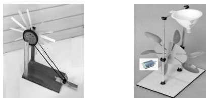
Фиг. 2. Експерименти за преобразуване на механична енергия (течаща вода) в електрическа [4]
