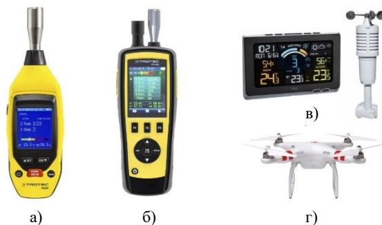
Фиг. 3. Уреди за измерване на ФПЧ и метеоданни: а) и б) лазерни броячи на ФПЧ; в) метеорологична станция; г) дрон.
