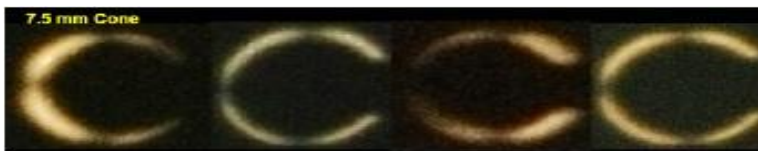
Фиг. 1: Центриране на топчето в областта на светлинното поле в четири положения на гентри-то ( 0^\circ , 90^\circ , 180^\circ и 270^\circ ). Използван е конус с размер 7.5 mm [1].
