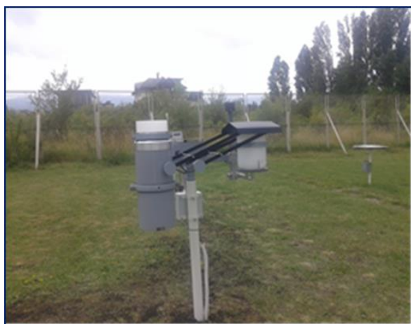
Фиг. 1: Автоматично пробовземащо устройство WADOS (Kroneis GmbH).
