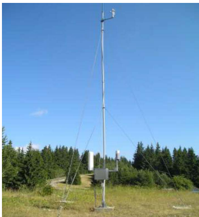
Фиг. 4: Мачта на ЛМС Рожен – гама-сонда и метео станция.
