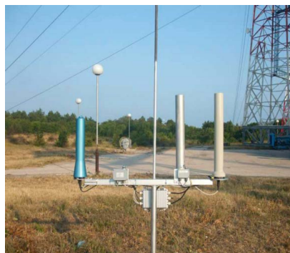
Фиг. 5: Снимка на обновените сензори на една ЛМС. В ляво е спектрометричната сонда, по средата е старта и в дясно е новата дозиметрична сонда.
